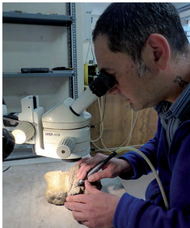
Fig. 3 - Nel laboratorio di Paleontologia del Museo di Storia Naturale di Milano, Fabio Fogliazza rimuove con un microscalpello pneumatico la roccia in cui, per 112 milioni di anni, è stata intrappolata la vertebra di "Tito". (Foto: Cristiano Dal Sasso).
