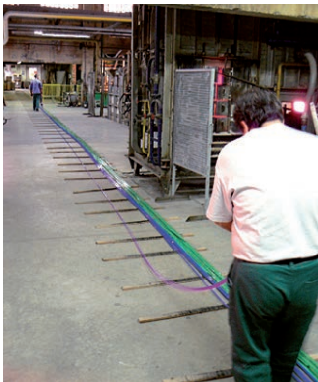
Si tirano canne da perle alla Effetre di Murano. / Drawing bead canes at Effetre, Murano.
