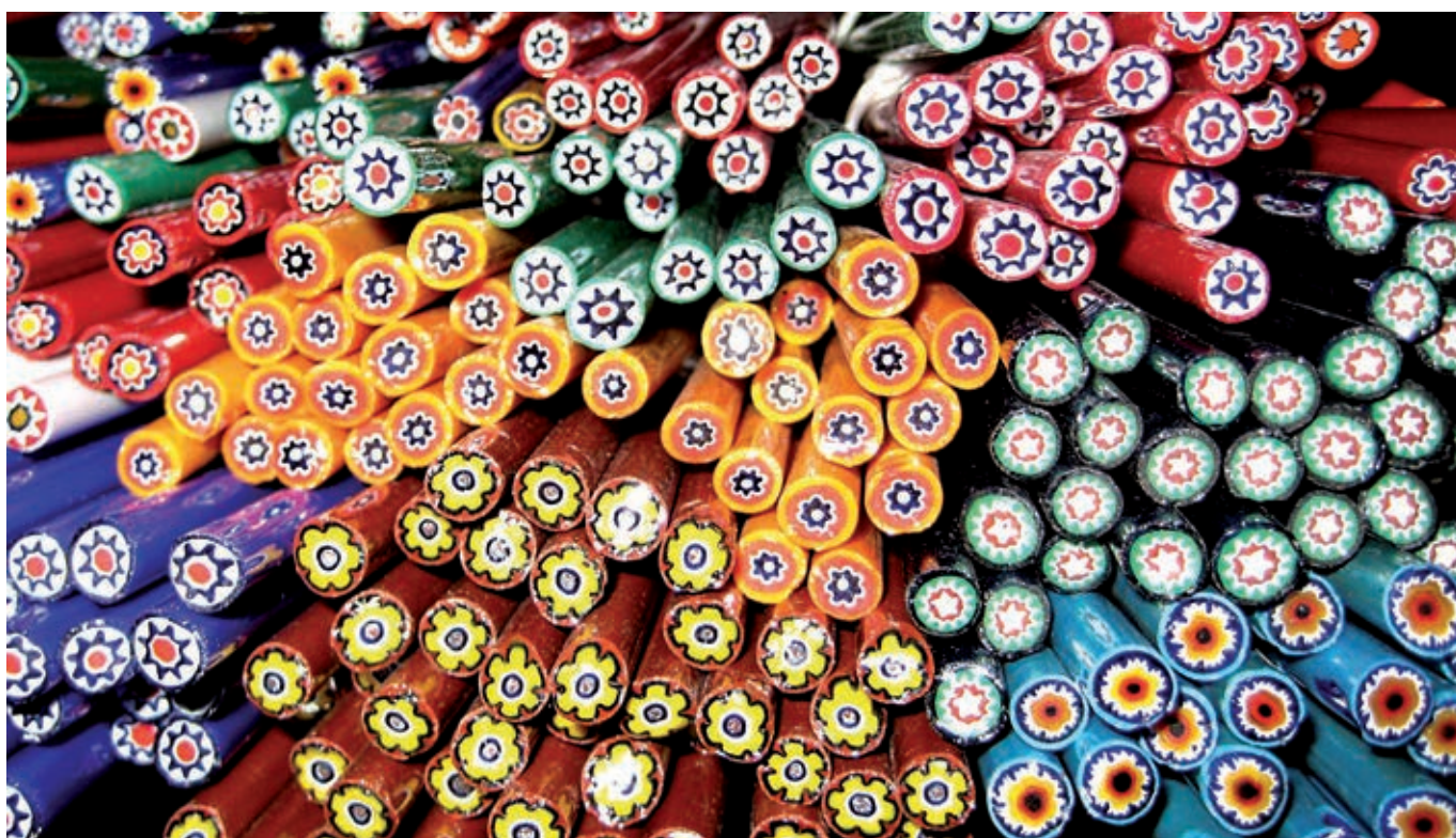
Canne da perle millefiori alla Ercole Moretti di Murano; si noti il disegno interno, che si ripete per tutta la lunghezza della canna. / Millefiori bead canes at Ercole Moretti, Murano. Note the internal patterns that run the whole length of the canes.
