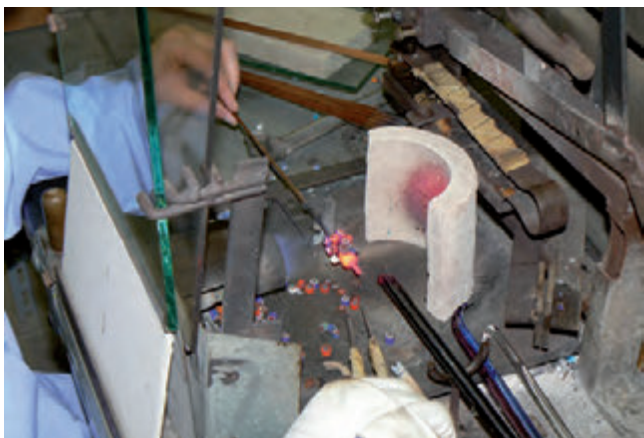
Le fettine di canna, o murrine, vengono poste su un nucleo di vetro fuso per ottenere una perla millefiori. / Cane discs, known as “murrine”, being arranged on a core of molten glass for the production of millefiori beads (Per cortesia della / Photo courtesy of Ercole Moretti, Murano).
